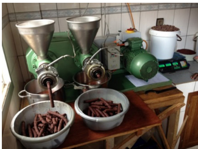
Fig. 5. Pressage des fèves de cacao dans l'extrudeuse KOMET DD 85-G. Laboratoire de pressage de Yaoundé.
